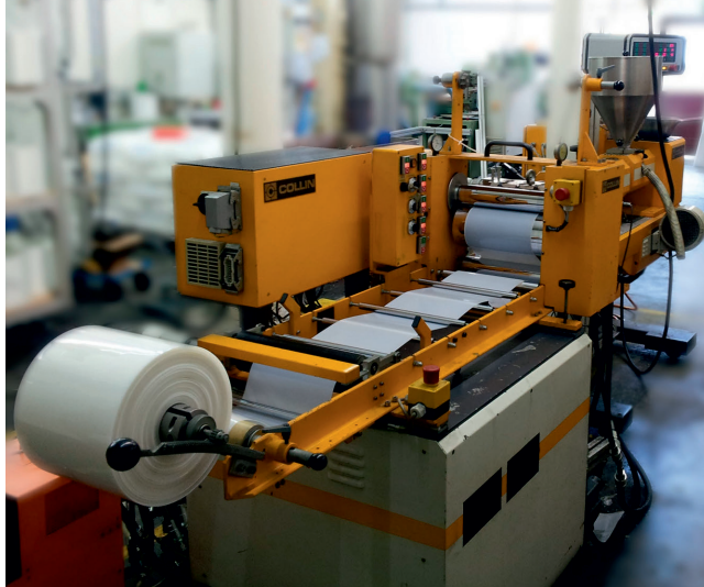
Bild 1. Folienabzug mittels Kalandrier- einheit © IKT
