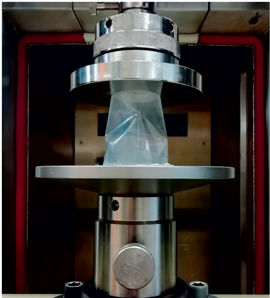
Um das Einsparpotenzial der Rezepturen für Thermoformfolien unter Laborbedingungen prüfen zu können, wurde ermittelt, welchen Stauchwiderstand die aus den Halbzeugen hergestellten Becher einer Verformung entgegenseetzen © IKT
